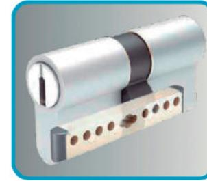
Este cilindro es el punto de entrada al mundo de la seguridad, con una protección contra rotura y taladro. Montado con un puente de latón, 15 pines de acero y rotores de inserción trasera.
