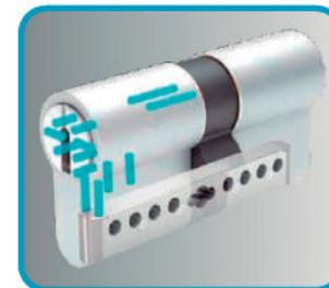
El cilindro PREMIUM proporciona la mejor protección contra la perforación y la extracción. Con el máximo grado de certificación tanto español como europeo. A través de pasadores de carburo de tungsteno en el rotor y en el cuerpo, un puente de acero reforzado, así como un cuerpo construido totalmente en acero Cromo Níquel reforzado, resisten los ataques con herramientas de WIDIA y HSS, así como extractores. El cilindro para los más exigentes.
